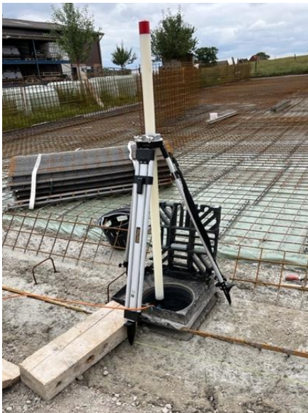
Dichtheitsprüfungen mit zugelassenem Pegelmeßgerät (0,1 mm)
